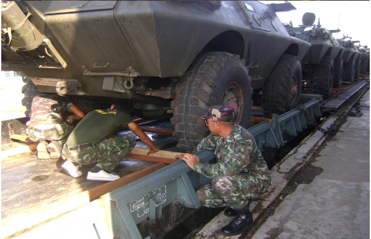
การยึดตรึงใช้ไม้ 2.50 ม.16 อัน ไม้ 5 ม. 6 อัน เหล็ก 16 เส้น ตะปู 2 กก.
