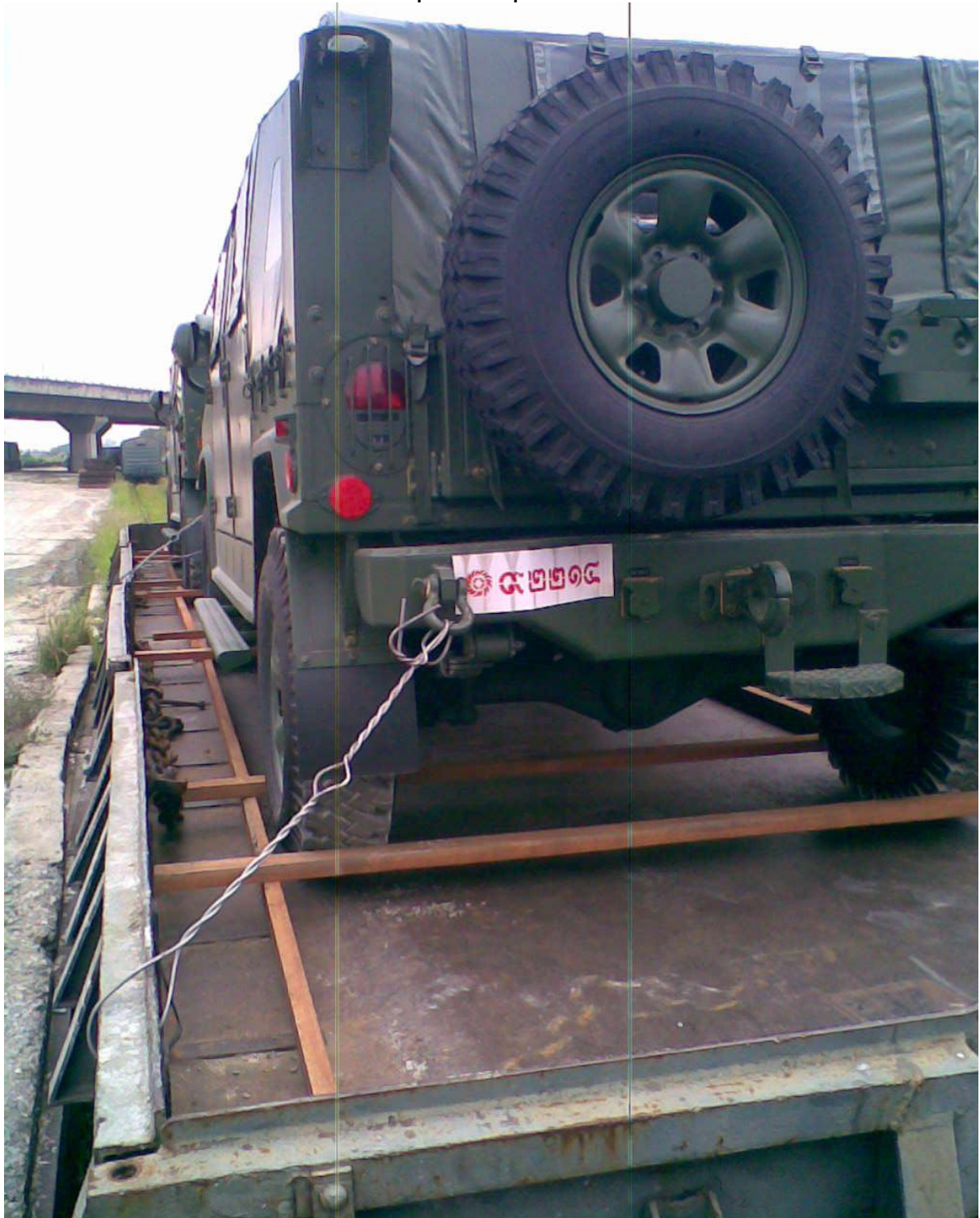
การยึดตรึงยานพาหนะขนาดเล็ก ใช้ไม้ยาว 2.50 ม.8 อัน ไม้ยาว 5 ม.
